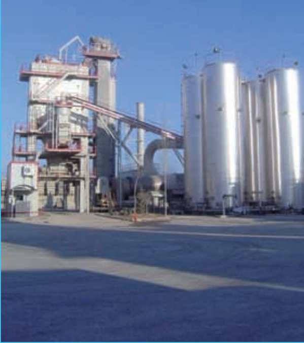
Foto 2. Planta discontinua con incorporación de materiales fresados mediante un sistema de pesaje y alimentación independiente.
