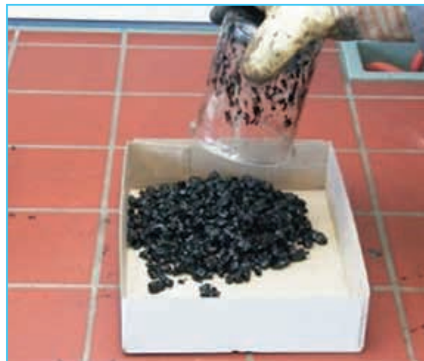
Foto 4. Método de Schellenberg, de escurrimiento del ligante, paso 3.
