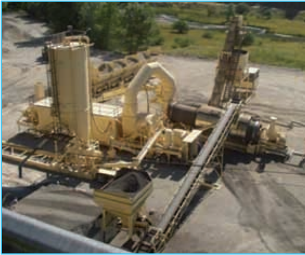
Foto 6. Planta continua, de tambor secador tipo double barrel.
