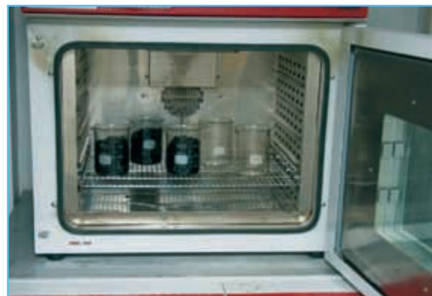
Foto 3. Método de Schellenberg, de escurrimiento del ligante, paso 2.
