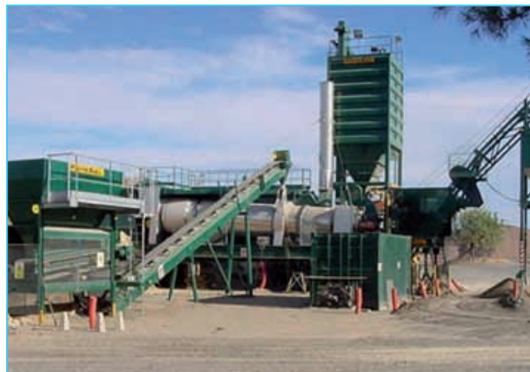
Foto 5. Planta continua, de tambor secador en contracorriente y quemador avanzado, con incorporación de material fresado por anillo central.
