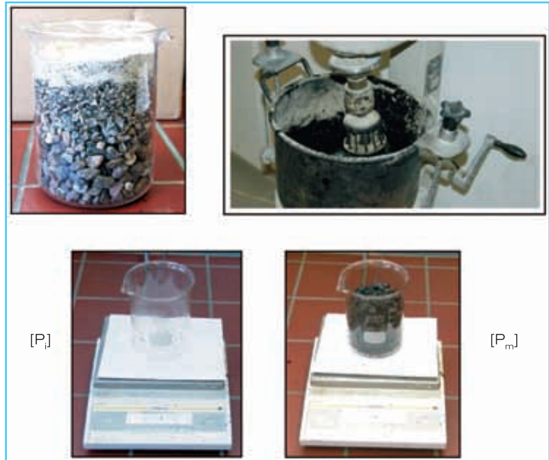
Foto 2. Método de Schellenberg, de escurrimiento del ligante, paso 1.
