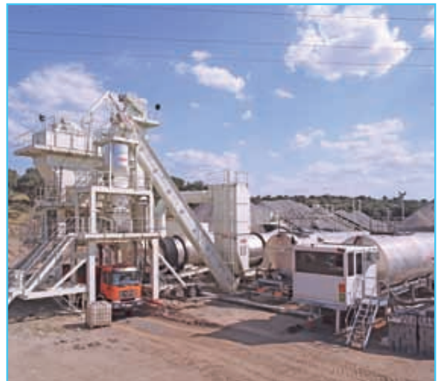
Foto 3: Ejemplos de planta discontinua con tambor secador independiente para secado de los materiales fresados, equipados para trabajar con altas tasas de reciclado.
