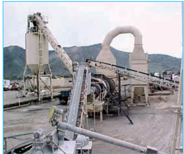
Foto 4. Planta continua, de tambor secador en equicorriente, con incorporación de material fresado por anillo central.
