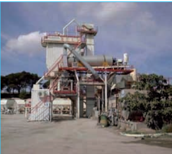
Foto 3: Ejemplos de planta discontinua con tambor secador independiente para secado de los materiales fresados, equipados para trabajar con altas tasas de reciclado.
