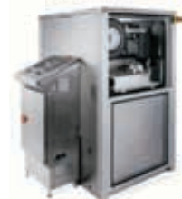
Wheel tracking de gran escala (más de 13 toneladas)
