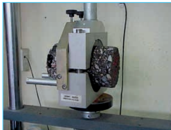
Foto 4. Dispositivo de ensayo para la medida de la adherencia entre capas (Método CEDEX).
