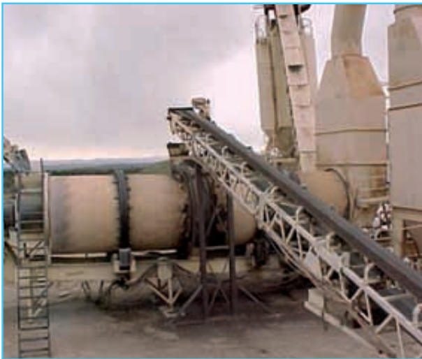
Foto 4. Planta continua, de tambor secador en equicorriente, con incorporación de material fresado por anillo central.
