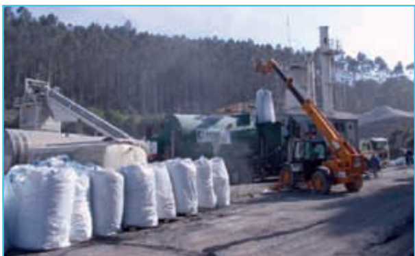
Foto 5. Fabricación a pie de planta y aplicación de una mezcla con un betún de alta viscosidad con caucho.
