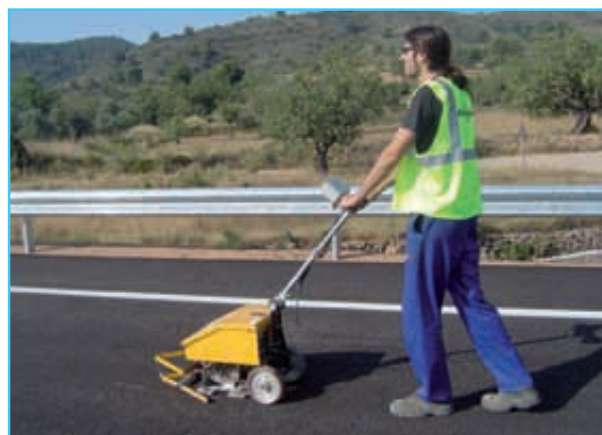
Foto 3. Utilización en carretera del perfilómetro rodante.
