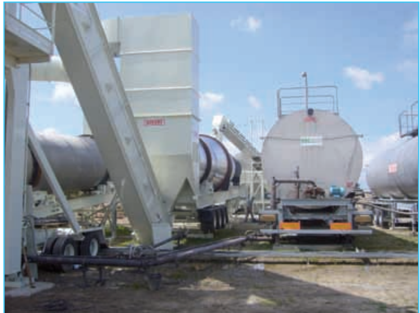
Foto 3. Integración del sistema de reciclado en una planta asfáltica UM-200: Integración del secadero de reciclado con el de la planta asfáltica.
